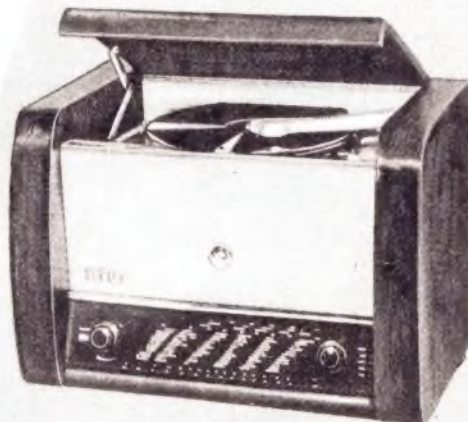
⑤ BRAUN-Phono-Super 770 WUK (AM/FM) 6 Röhren — 6 Kreise, eingebauter Plattenspieler, Magisches Auge, 4 Wellenbereiche, 4 gespreizte Kurzwellenbänder, 5-Watt-perm- dyn.-Lautsprecher, optische Band- breitenanzeige, optische Wellen- bereichsanzeige, hochglanzpoliertes Nußbaum-Edelholzgehäuse, Schwungradantrieb, Wechselstrom. Geh.-Abmess.: 570 x 380 x 355 mm. EB-Röhrensatz: ECH 42 EL 41 EF 41 EM 11 EBC 41 AZ 41
