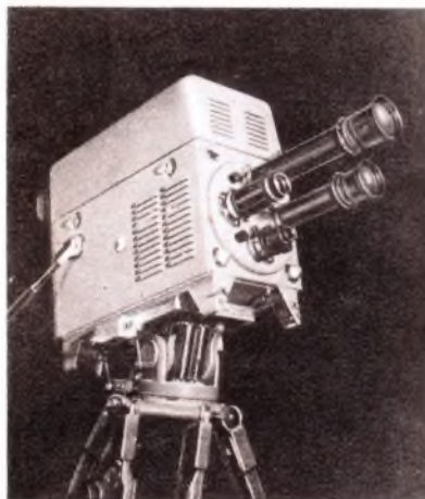
Zu den modernsten Entwicklungen der Fernsehtechnik zählt diese neue Bild-Orthikon-Kamera, die aus den Marconi-Laboratorien stammt
