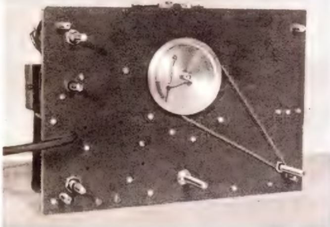
Diese Aufnahme zeigt die Zwischenfrontplatte, die aus Abschirmungsgründen angeordnet ist. Sie enthält vier Zwischenstücke zur Befestigung der eigentlichen Frontplatte
