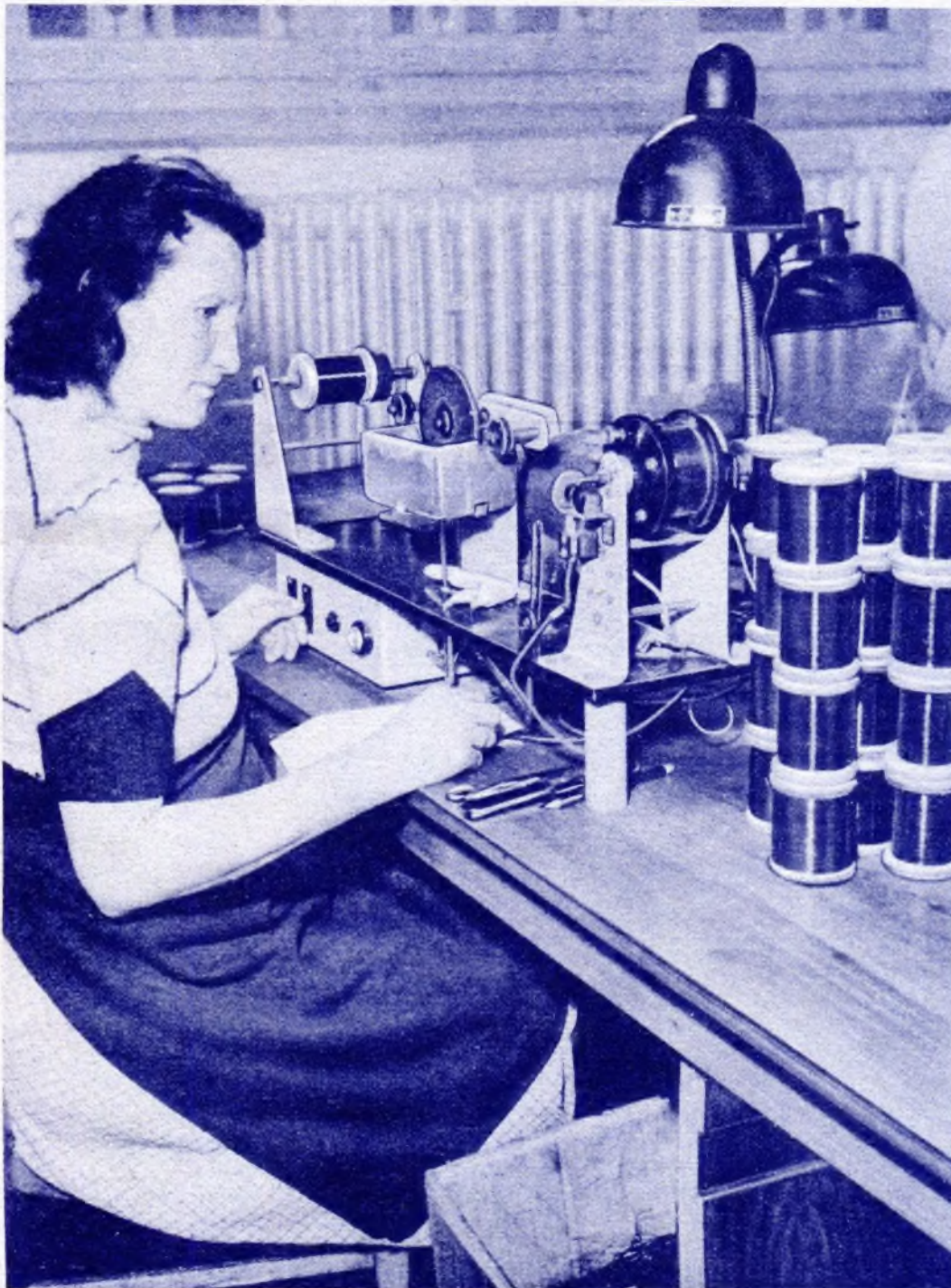
Im Telefunken-Rundfunkgerätewerk Hannover werden automatische Drahtprüfmaschinen verwendet, die eine Prüfung der lackisolierten Drähte auf Fehler ermöglichen. Die abgebildete Maschine wickelt selbsttätig eine einstellbare Länge Draht auf und führt ihn dabei durch ein elektrisch leitendes Bad. Bei Fehlern in der Isolation wird über den zu prüfenden Draht und das Bad ein Stromkreis geschlossen, der mit einem Zählrelais die Zahl der Fehler registriert.
