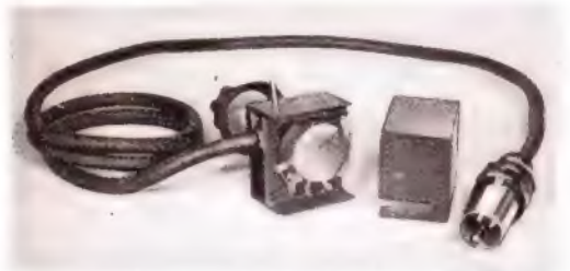
Um kleine HF-Spannungen einstellen zu können, muß der Ausgangsspannungsregler sorgfältig abgeschirmt werden. Er ist hier mit dem zugehörigen Abschirmkästchen und dem HF-Abschirmkabel mit Anschlußstecker sichtbar
