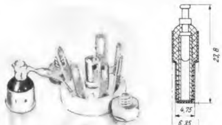
Überbrückungskondensator neben einer Röhrenfassung und im Schnitt
