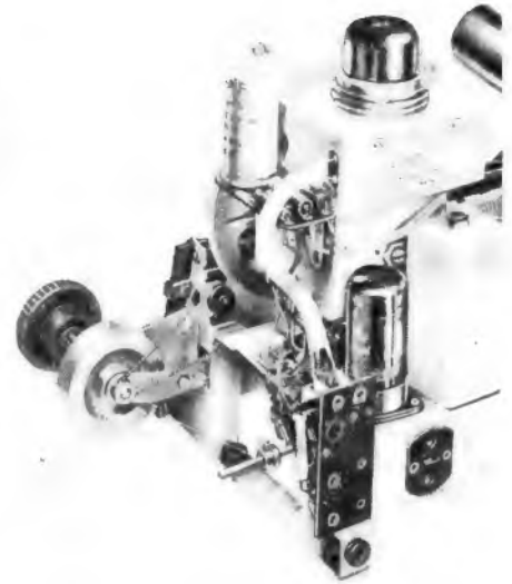
Chassis-Teilansicht mit UKW-Einsatz
