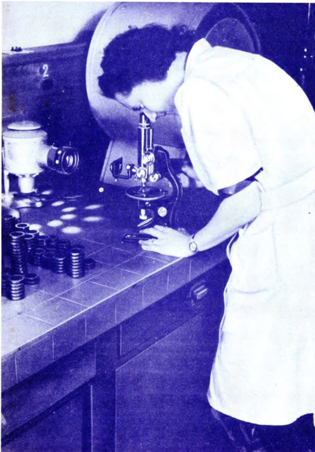
Die Herstellung von Ferrocart-Bauteilen verlangt sorgfältige Materialprüfungen. Dieses Bild zeigt die optische Untersuchung von Hf-Eisenkernen, wie sie von der Firma Vogt & Co. vorgenommen wird. (Werkbild)
