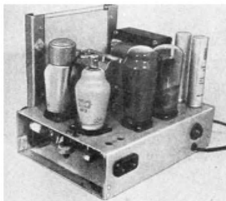
Bild 2. Rückansicht des fertigen Chassis
