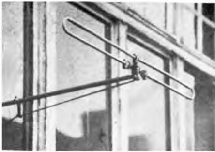
Bild 7. Schleifendipol vor einer Hauswand
