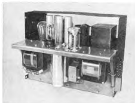
Bild 2. Endstufe mit Vorverstärker zusammengebaut (Schutzgehäuse abgenommen)
