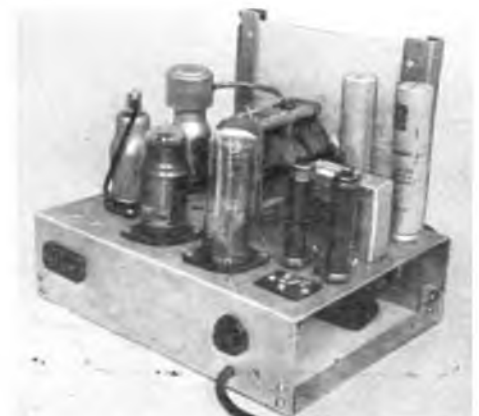
Bild 8. Chassisansicht der Allstromausführung
