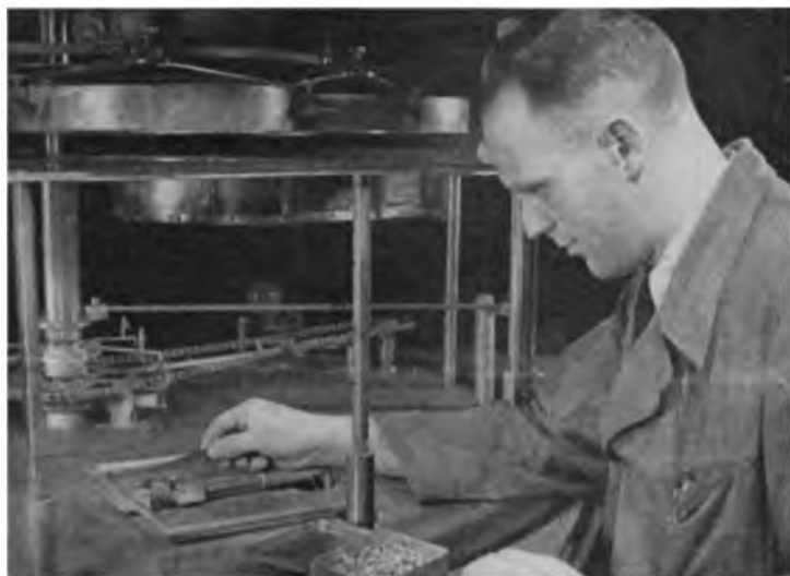
Einlegen von Silberstückchen in den Verdampfer zur Versilberung der Schallplattenwache.
