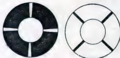
Bild 2 und 3. Die Anzeige bei normaler Aussteuerung (links) und Übersteuerung (rechts).
