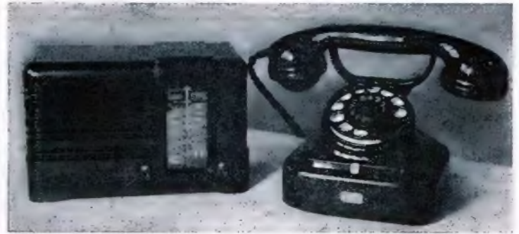
Bild 1. Kleinstsuper FIDO II von MARELLI, Mailand, im Vergleich zu einem Fernsprechapparat.
