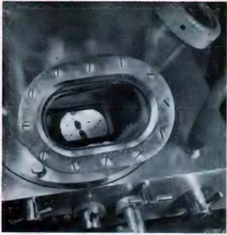
Bild 6. Blick durch ein vakuumdichtes Einblickfenster auf den Bildschirm im Siemens-Übermikroskop.
