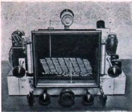
Blick auf die Drehknopf-anordnung auf der Frontseite mit dem Kombinations-schalter (unten links), dem Klangregler und damit vereinigten 9-kHz-Sperre-Schalter, Doppeltrieb-Stationswähler, Lautstärkeregler und Netzschalter sowie rechts Bandbreitenregler. Links von der Skala sitzt der Belastungsschalter S_3 (Sende-Empfangsschalter), rechts davon der Abstimmknopf für Telegraphietonhöhe und Einzelzeichenempfang.
