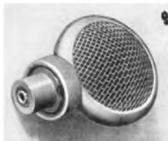
Die Kapsel des neuen Kristallmikrophons.
