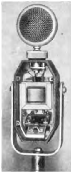
Kristallmikrophon mit eingebautem Übertrager. (Werkbilder: Körting - 3)
