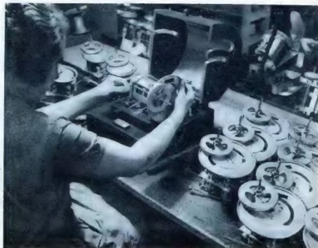
Hier werden Drehkondensatoren auf Kurven- und Gleichlauf-Genauigkeit geprüft. (Werkbild: Ideal-Werke)
