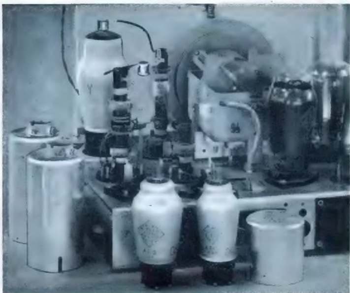
Der Hochfrequenzteil des „Siemens 82“, Abschirmkappen abgenommen.
