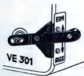
Wie der Schalthebel beim VE 301 angebracht wird. (Werkaufn: Hellogen)
