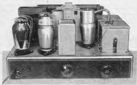
Die Wechselstromausführung von rückwärts gesehen. Auf der rückwärtigen Leiste die Knöpfe für Rückkopplung und Sperrkreis.
