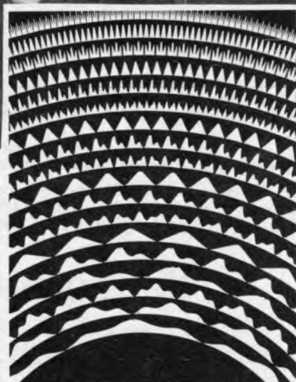
Ein Ausschnitt aus einer der zur Anwendung gelangenden Scheiben. Kreisförmig ist die Zackschrift eingetragenen.
