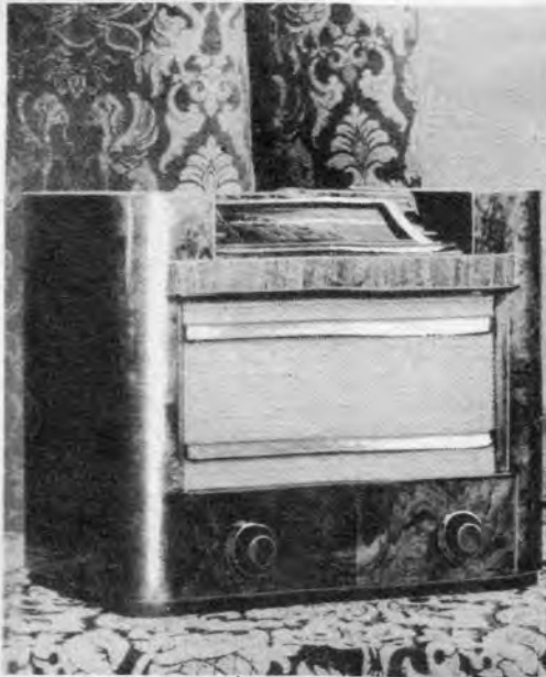
Der Siebenkreis-Dreiröhren-Superhet der Deutschen Philips-Gesellschaft „Aachen-Super D 48“ mit der Klappkassette. Ihm äußerlich fast völlig gleich ist der Vierrohren-Super der gleichen Firma.
