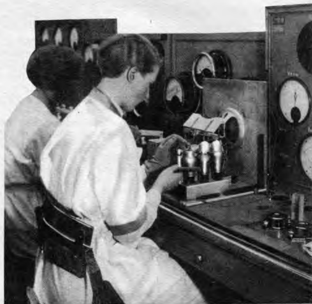
Eine der vielen, vielen Prüfungen, die jede Röhre zu bestehen hat: Die Klopfprüfung mit einem Gummistab, die zeigen soll, ob die Röhre Kratzen, Krachen oder Brummen verursacht.
