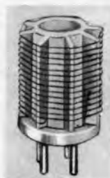
Eine KW-Steckspule mit Stiffköckel, selbstverständlich unter Verwendung eines keramischen Wicklungsträgers. Werkphoto Undy.
