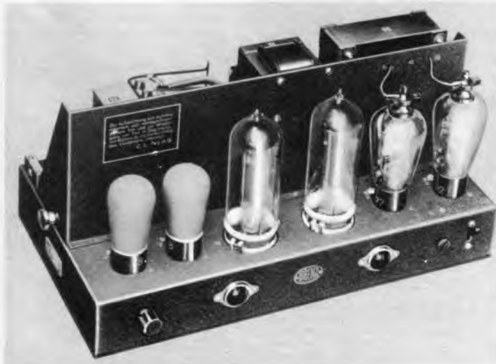
Ein Lorenz-20-Watt-A-Verstärker, dessen Schutzhaube abgenommen ist. Werkphoto.
