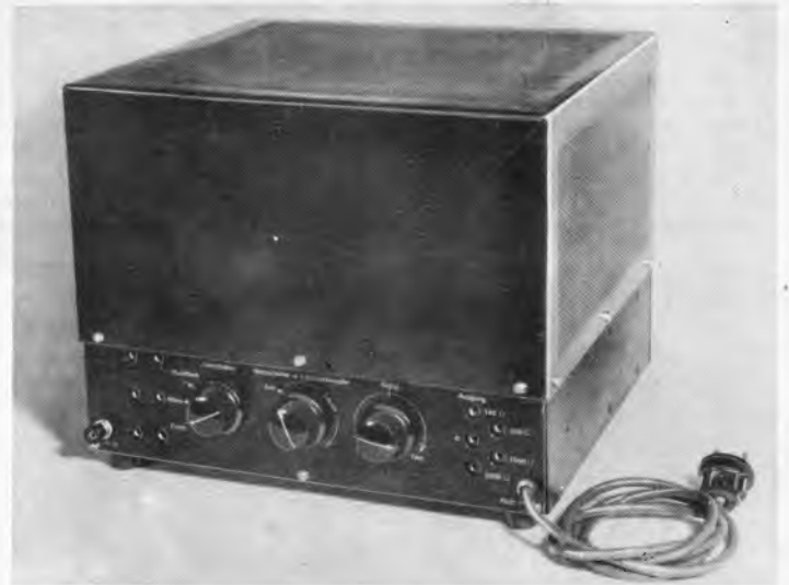
Kraftverstärker haben selten einen festen Platz. Sie werden hier und dort eingesetzt und deshalb gibt man ihnen ein Äußeres, das Beschädigungen jeder Art ausschließt. Eine Philips-Kraft-Endstufe. Werkphoto.
