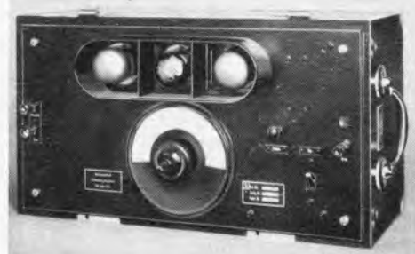
Abb. 2. Die Vorderansicht des Tonfrequenzgenerators. Werkphoto Siemens & Halske.
