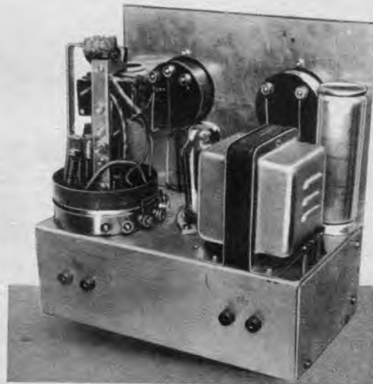
Rückansicht des Gleichstrom-Spannungswandlers. Die Abschirmhaube des Zerkhackers ist abgenommen. Mit Vorteil führt man bei Anschluß an das Netz die Anschlußstelle als Stecker aus.
