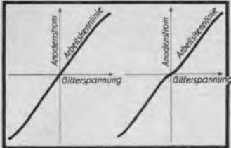
Abb. 8. Gesamt-Arbeitskennlinien im Anodenstrom-Gitterspannungsbild für Gegentaktstufen. Die linke Arbeitskennlinie gehört zum A-Betrieb, die rechte zum B-Betrieb.
