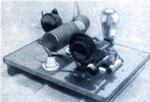
Praktische Ausführung eines Hartley.
