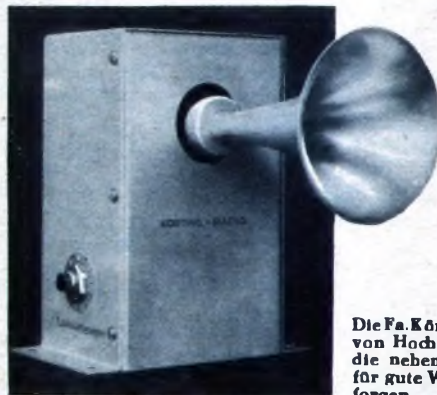
Eine Ausführung, die zum erstenmal zu sehen war: Ein Rundstrahler aus Holz. (Werkphoto Peter Graßmann)
