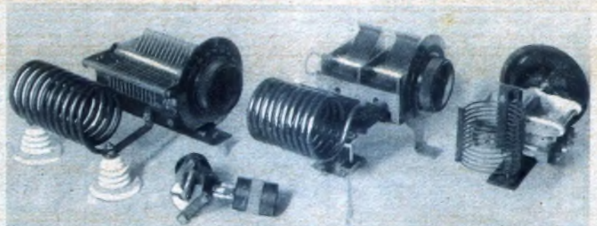
Abb. 17. Einige Anodenschwingkreise für verschiedene Leistungen. Von links nach rechts: für etwa 50 100 Watt, für etwa 25 Watt (Doppelkondensator) und für noch kleinere Leistungen.
