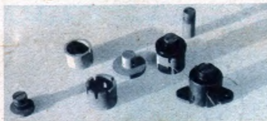
Das ist wieder die Ferrocart-Topfspeule mit Isoliergehäuse bzw. Isolierkappe. Die Schlitze im Isoliergehäuse und im Mantel ermöglichen die Herausführung der Wicklungsenden.
