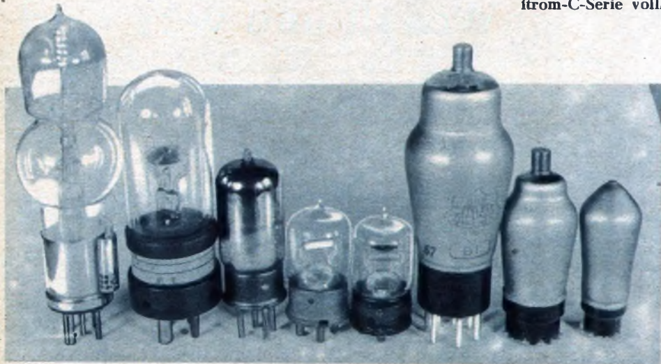
Ein eindrucksvolles Bild von der Röhrenentwicklung der vergangenen 20 Jahre. Ganz links die ursprüngliche Lieben-Röhre, dann eine Röhre, wie sie die Feldzugsteilnehmer kennen werden. An 3., 4. und 5. Stelle Röhren aus den Anfängen der Rundfunkzeit, dann eine moderne Röhre, aber noch mit der alten Sockelung, und schließlich zwei ganz neue Röhren mit der neuesten Sockelung. Es ist auch recht interessant, sich die Gründe zu überlegen für die Wandlungen des Glaskolbens in Form und Größe.
