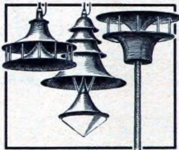
Drei Rundstrahler, — Großlautsprecher, wie sie bei Massenveranstaltungen Verwendung finden. Die beiden linken Ausführungsformen werden hängend angebracht, während rechts der bekannte Telefonen-Pilzlautsprecher dargestellt ist. Der mittlere Lautsprecher trägt an seinem unteren Ende eine Lampe, teils zur Schallführung, teils aus Schönheitsgründen und schließlich vielleicht auch, um den Platz besser auszunützen.
