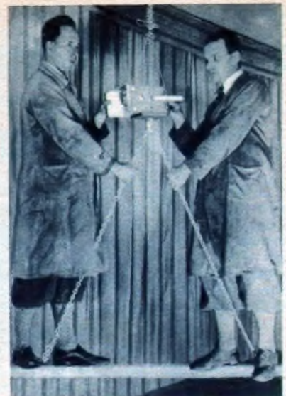
Solche Riesenkräfte bringt ein moderner Permanent-Magnet für dynamische Lautsprecher auf. Er kann zwei ausgewachsene Männer tragen. (Mit Genehmigung von Körting-Radio, Leipzig.)
