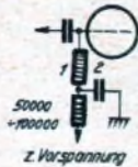
Abb. 12. Die Gittervorspannung wird gefiebt durch einen Vorwiderstand und Block in der Gitterleitung.
