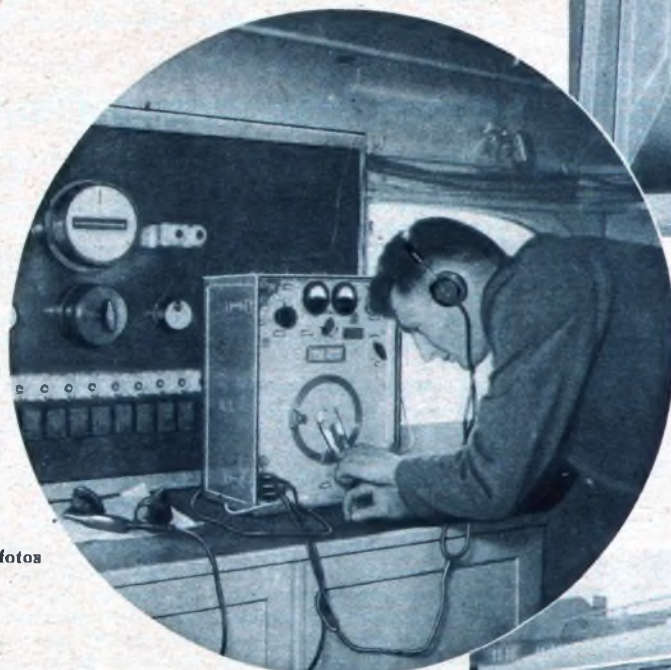
Zu einer Säule vereinigt sind die einzelnen Verstärkerstufen im rückwärtigen Teil des Regiewagens. Dahinter ein Mikrophult.
