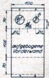
Die Abmessungen der Vorderwand.
