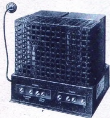
Eine 9-Watt-Endstufe zum Anschluß an den Rundfunkapparat. Werkphoto Dr. Dietz & Ritter.
