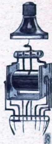
Die praktische Ausführung der 5-Pol-Röhre. Das umgebende, zweimal abgehobene Blech, das sich im Zylinder fortsetzt, ist das Schirmgitter, der äußere Zylinder der Fangpol.
