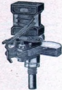
Links der Einbausperrkreis mit Trolitul-Drehko und Eifenkernspule. - Oben die kleine HF-Droffel.
