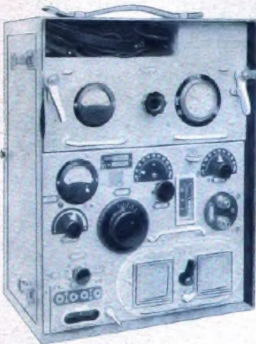
Der Empfänger der Tornisterstation — stabil bis zum Äußersten. — Und etwas viele Bedienungshebel, werden unsere Rundfunkhörer sagen. Aber diese vielen Hebel haben schon ihre Vorteile!
