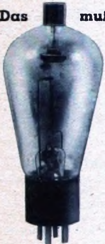
Eine Quecksilberdampf-Gleichrichterröhre für höhere Leistung und rechts eine Kurzwellen-Senderöhre.
