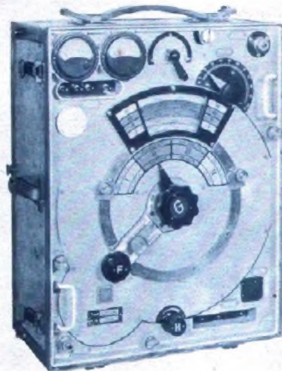
Der Sender. Wie man sieht, verfügt er über vier Wellenbereiche, von 96 bis 316 m.
