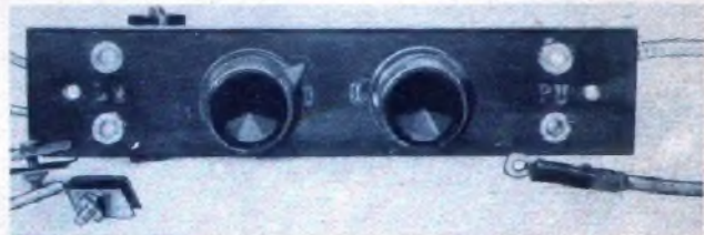
Das kleine Zusatzgerät von oben und von rückwärts gesehen. Rechts der Lautfärkereger. Links die Tonblende.
