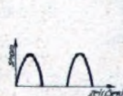
Fig. 2 e: Eine Wechselstromamplitude ist abgeschnitten.
