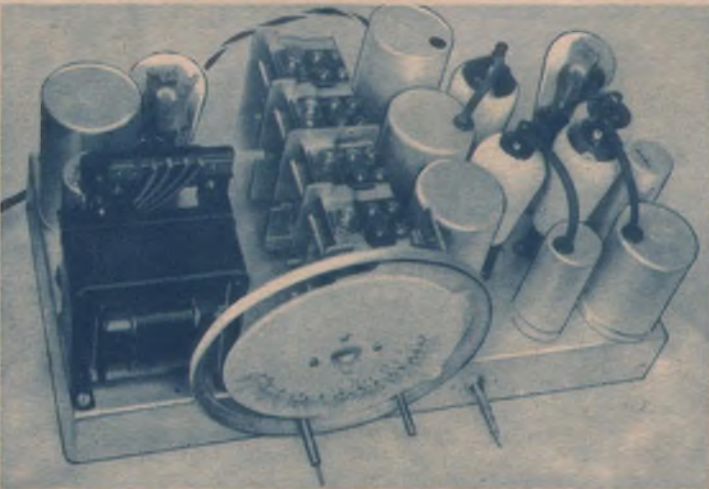
Das ist das Chassis des Imperial 5a, besonders interessant ist das Vierfachdrehko-Aggregat.
