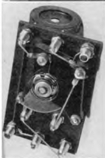
Der Sperrkreis ist ein Apparat für sich, der auch für Detektorempfang Verwendung finden kann.
