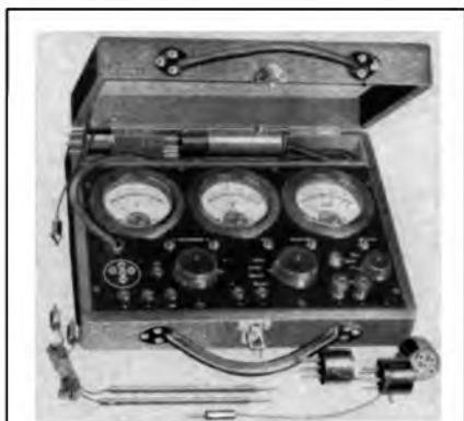
Dieses Prüfgerät ist originell dadurch, daß es die Röhre zu messen gestattet in der betriebsmäßigen Schaltung im Gerät.
