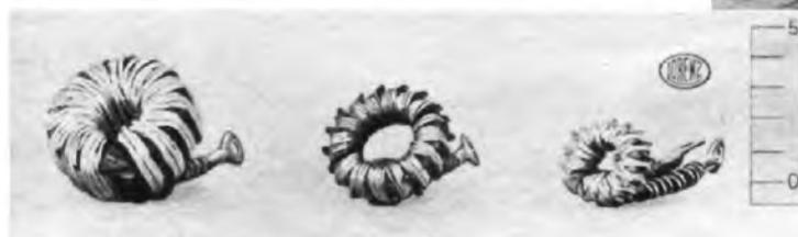
Links: Abb. 3. Die Spulen, in denen die Frequenz vervielfacht wird. Das Eisen in den Spulen wird durch die Verarbeitung teurer als Gold.
