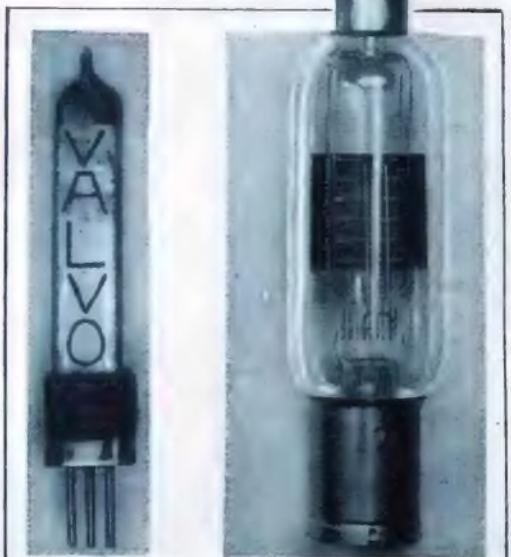
Links eine Stabröhre, wie sie auch Valvo herausbringt. Rechts eine Fernsehglühlampe (Vergleiche auch den Artikel Seite 310)
