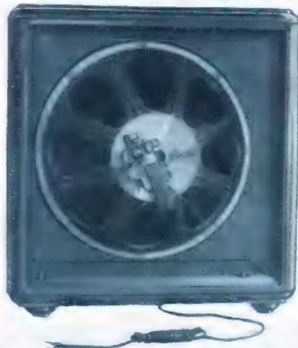
Das selbstgebaute Kabinett mit dem 37-cm-Chassis und 66-R-System von hinten vor dem Festschrauben der Abschlußwand.
