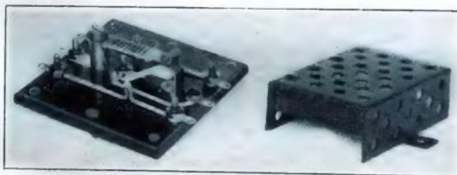
Das fertige Verzögerungsrelais.
