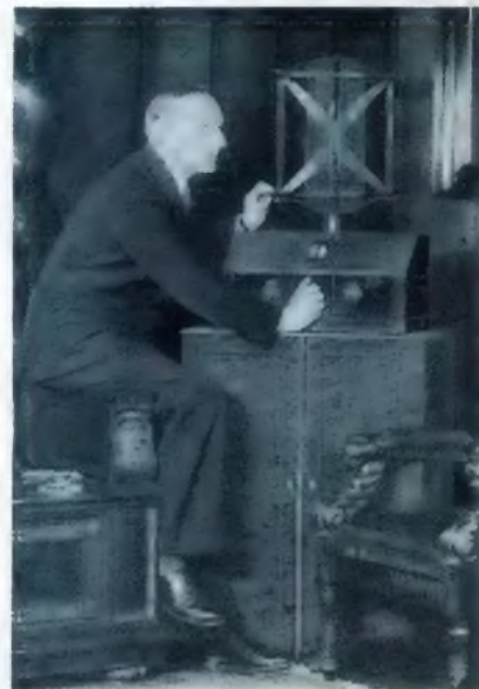
Mit einem leistungsfähigen Rahmengerät ist auch in der Großstadt relativ ungestörter Fernempfang möglich.
