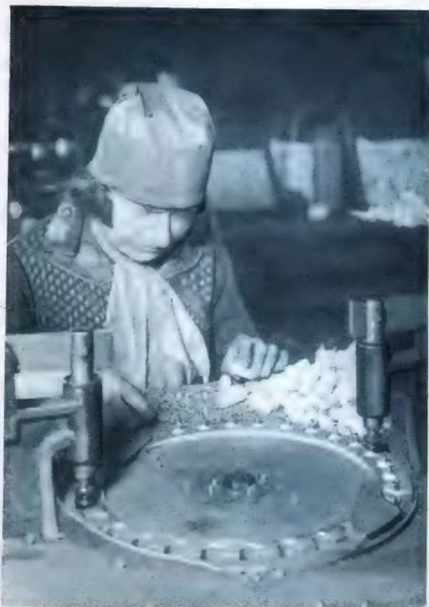
Mit jedem Stempeldruck erhält ein Beutelement sein Messinghütchen.
