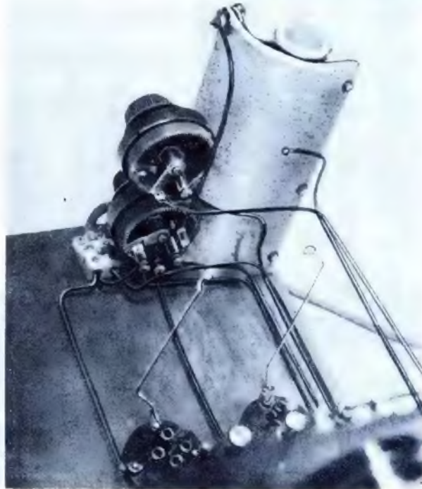
Die Leitungen zum Regulierwiderstand und zum Potentiometer. Hinter der Asbestwand der große Vorwiderstand R_1 . Beachte die Stifte am Drehwiderstand R_2 (unten), die ein Überheizen und ein vollständiges Ausschalten beim Einregulieren verhindern.
