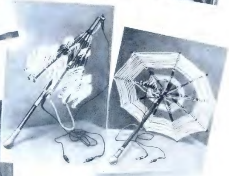
Eine eigenartige Antenne Die Antenne in Form des Schirmes ist originell und praktisch. Sobald man den Schirm öffnet, findet der Empfang statt.
