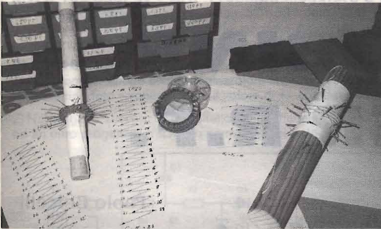
Foto 2 - Bobina (in parte originale commerciale) in parte ricostruita perché schiacciata in RX autocostruito (Francia) 1920±25.
