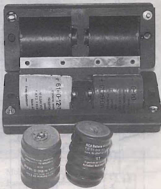
Foto 3 - FSE scatola con batterie di ricambio.
