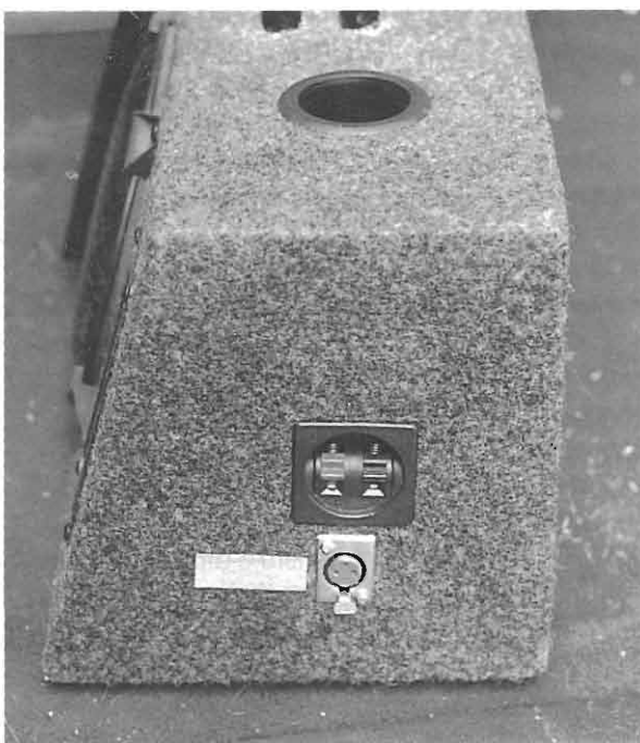
Foto 6 - Connessione ingresso e alimentazione realizzati con connettori professionali.
