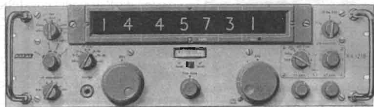
Foto 4 - Ricevitore HF-transistorizzato RA.1218 con display per la visualizzazione della frequenza.
