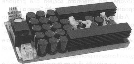
Sistema elettronico di autoregolazione della lampada.
