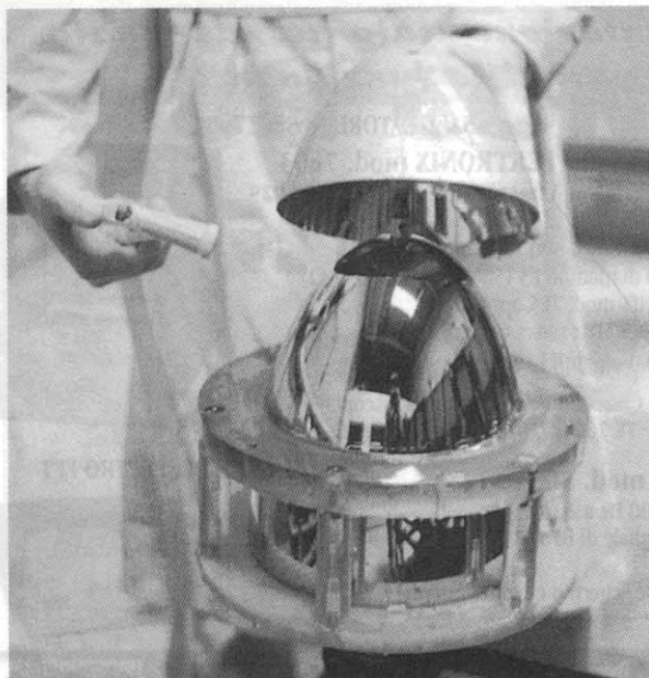
Realizzazione accuratissima della parabola di riflessione del faro, il cui relativo controllo di messa a fuoco elettronico è esclusivo della Space Cannon.
