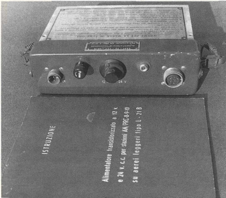
L'alimentatore transistorizzato ed il suo manuale originale.
