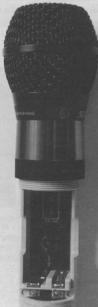
L'interno del microfono senza filo, particolare del vano pila, per elemento 9V piatto; sul fondo il trimmer di livello di uscita audio.
