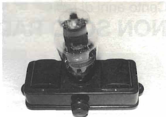
Foto 5 - Amplificatore BF ad una valvola.
