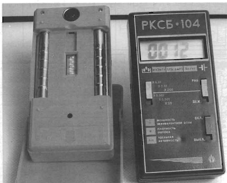
Foto 6 - PKCb-104, con il contenitore in dotazione, uno è visto dal lato posteriore ed è senza sportellino. Sono visibili i due tubi geiger, otto DipSW per i settaggi e la presa DIN in alto. I due strumenti sono di colore diverso.
