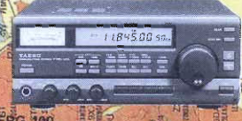
FRG 100 Ricettore multimodo HF (da 50 KHz a 30 MHz) Alta sensibilità e doppia conversione in SSB CW AM FM 80 memorie
