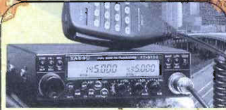
YAESU FT 5100 - Ricetrasmittente veicolare con Duplexer incorporato RxTx 144-148 MHz 430-440 MHz.
