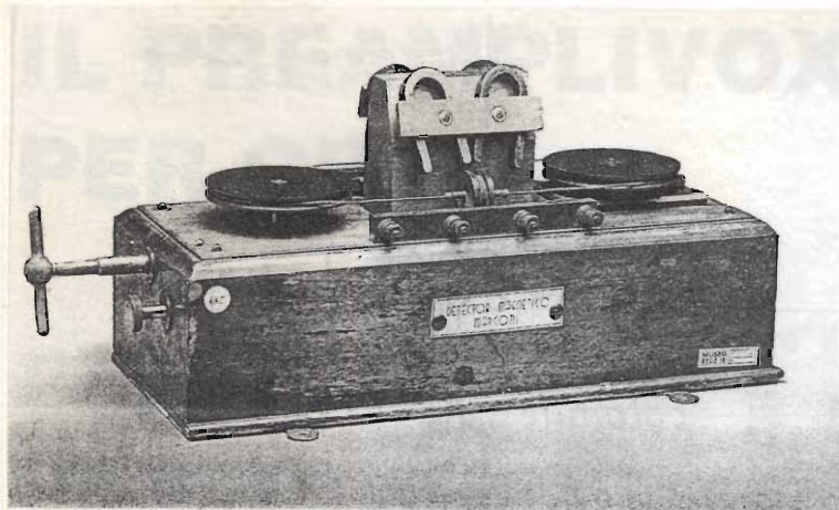
"Maggie" nella versione professionale con funicella senza fine comandata da un motorino a molla per evitare QRM locale.
