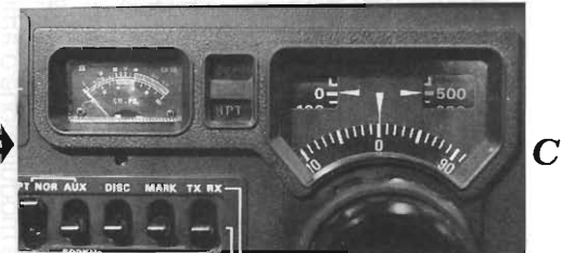
figura 10 - Esposizione di alcuni momenti significativi durante la misura con apparato All-mode in posizione FM. Il generatore RF, posto al centro, è applicato al ricevitore ed all'analizzatore di spettro di cui si riporta il print sulla sinistra. Il segnale modulante è 1500 Hz. In A, con \delta F = 0 , vediamo, ovviamente, solo la portante, e lo S-meter indica un certo valore. In B, con \delta F = 3,62 \text{ kHz} ( m = 2,41 ), vediamo sull'analizzatore di spettro, la portante attenuata e lo S-meter indicare quasi 0 (resta un piccolo residuo dovuto alla presenza delle prime bande laterali all'interno del filtro). In C, con \delta F = 8,34 \text{ kHz} ( m = 5,52 ), si ha il secondo annullamento della portante e lo S-meter indica zero, essendo diminuita l'ampiezza delle prime bande laterali che rientrano nella banda del filtro del ricevitore.
