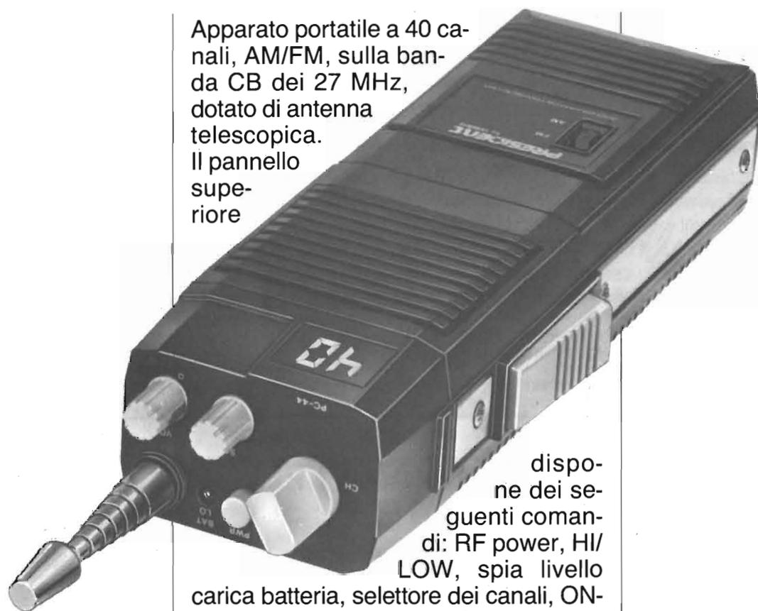
dispone dei seguenti comandi: RF power, HI/LOW, spia livello carica batteria, selettore dei canali, ON-OFF/Volume, squelch. Sul pannello frontale, invece, sono disposti il commutatore AM/FM e l'indicatore a led del canale operativo. Filtro ceramico per la selettività e reiezione al canale adiacente: ne risultano interferenze minime.
