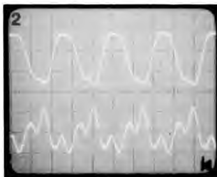
Foto 1 e foto 2. Gli ocllogrammi inferiori mostrano un segnale di chitarra non filtrato. E' evidente che ci saranno parecchi problemi quando si voglia applicare questi segnali ad un trigger di Schmitt. La traccia superiore è invece il segnale filtrato, che potrà essere agevolmente elaborato. Foto 1: 330 Hz; foto 2: 82 Hz.
