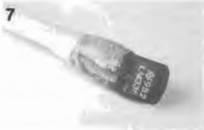
Figura 7. I due piedini del sensore LM 335 collegati al cavetto dovranno essere incapsulati in resina epossidica, come mostrato in questa fotografia.
