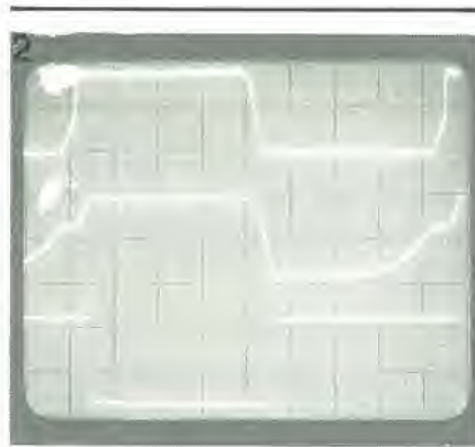
Fotografia 2. Quando un FET di potenza è pilotato da un CMOS, ci sono dei considerevoli ritardi perché il pilota non è in grado di erogare una corrente sufficiente per un rapido trasferimento della capacità di gate. Dall'alto verso il basso: il segnale di controllo proveniente dal buffer CMOS, la forma d'onda al gate del FET e la corrente che lo attraversa.
