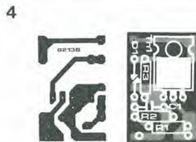
Figura 4. Il circuito stampato e la disposizione dei componenti per il circuito dello starter elettronico. Il gruppo montato è compatto a sufficienza da poter essere inserito nell'astuccio di un "vecchio" starter meccanico: per motivi di sicurezza, non si dovrà usare un astuccio metallico.
