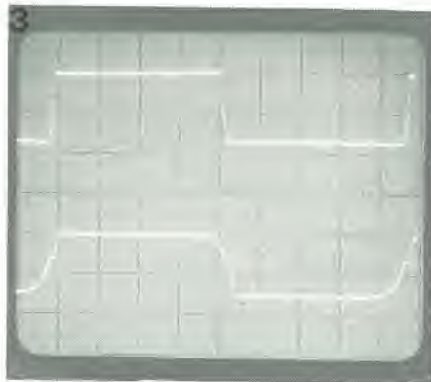
Fotografia 3. Tempi di commutazione migliori si ottengono pilotando i FET di potenza mediante un buffer TTL a collettore aperto. La migliore soluzione è di scegliere la tensione di controllo del gate con un livello doppio rispetto alla tensione di pilotaggio: in tal modo i margini di commutazione della corrente di drain saranno meno tormentati. Una maggiore tensione permette un rapido aumento della potenza necessaria al pilotaggio del gate (con il quadrato della tensione) e non abbassa la velocità.
