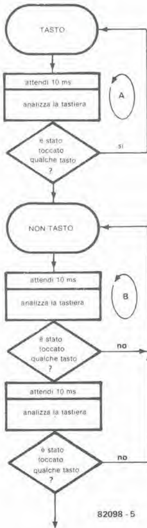
Figura 5. Basandosi su questo diagramma di flusso, si potrà scrivere un programma che abbia lo scopo di eliminare i rimbalzi dei contatti e di analizzare le condizioni della tastiera.
