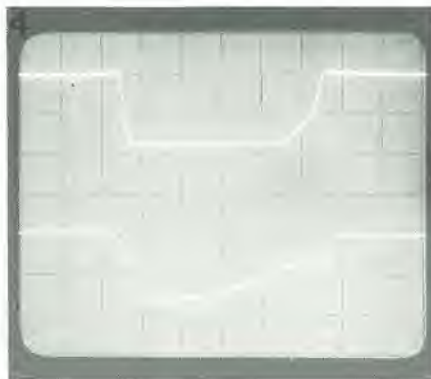
Fotografia 4. La tensione di gate durante il processo di commutazione. E' assai difficile predire il ritardo esatto, perché le capacità di gate dipendono dai livelli (intermedi) della tensione di drain. Lo stesso accade alla potenza necessaria per il pilotaggio, e questo è il motivo per cui alcuni produttori consegnano dei grafici che mostrano la forma d'onda della tensione di gate a diversi livelli della tensione di drain.
