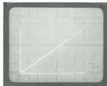
Fotografia 1. La caratteristica d'uscita del tachimetro. La scala orizzontale è di 100 Hz (3000 giri al minuto) per ogni divisione; la scala verticale è di 200 mV per divisione.
