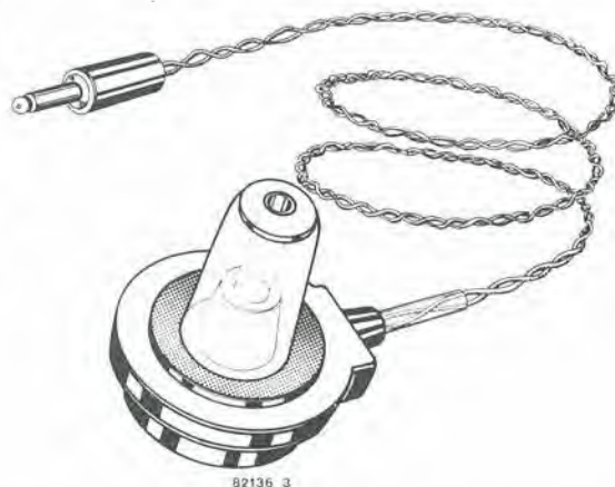
Figura 3. La costruzione della radiolina in una scatola di fiammiferi è illustrata qui. Il "telaio" è fatto di laminato plastico e si può infilare in una scatola di fiammiferi svedesi. C'è spazio in abbondanza per tutti i componenti compreso lo stadio d'uscita, se è necessario.
