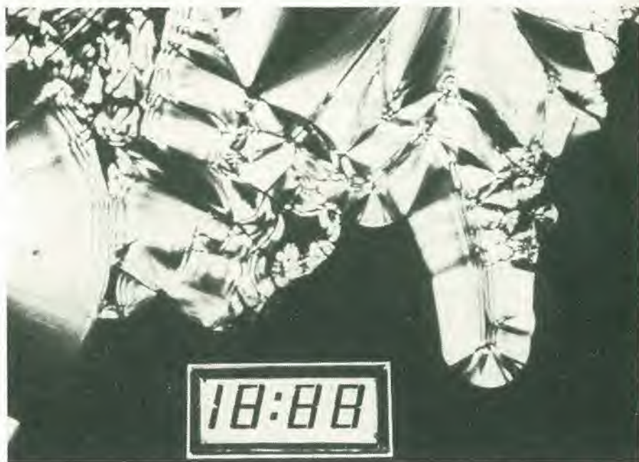
Fotomicrografia di un cristallo liquido smectico (vedi testo) con ingrandimento di circa 200. La fase a cristallo liquido è stata formata raffreddando un sottile film di liquido isotropico (sfondo nero) e risulta chiaramente ordinata nonostante il fatto che è scorrevole. In altre parole per quanto i cristalli liquidi siano fluidi, hanno molte delle proprietà ottiche dei cristalli solidi. Questo si traduce nella possibilità di produrle, usando dei cristalli liquidi nematichi che possono essere controllati elettricamente, il familiare tipo di display mostrato nella parte inferiore della foto.
