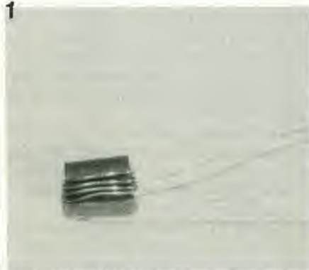
Fotografia 1. Vista degli avvolgimenti di blocco (impedenze) da L2 ad L5 ultimati. S'impiegano cinque spire di filo in rame smaltato da 0,2 mm bobinate in modo toroidale sul cilindretto di ferrite.
