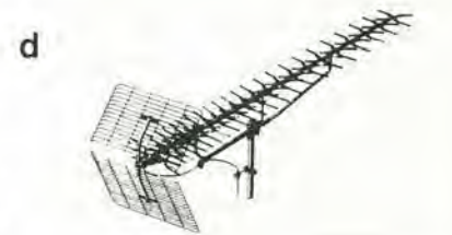
Figura 6. Un'antenna efficiente è il miglior amplificatore RF. I sistemi multielementi possono erogare un segnale più ampio del semplice dipolo pur senza generare alcun rumore inerente. Ciò è evidenziato dal grafico di figura 6a, che mostra il guadagno offerto dall'antenna come funzione del numero degli elementi. Le figure da 6b a 6d illustrano le antenne seguenti: 6b, un'antenna a 14 elementi per UHF dal guadagno di circa 12 dB. 6c, un'antenna a 13 elementi per VHF dal guadagno di circa 11 dB. 6d, un'antenna per UHF munita di ben 91 elementi! Il guadagno tipico è di circa 16 dB.
