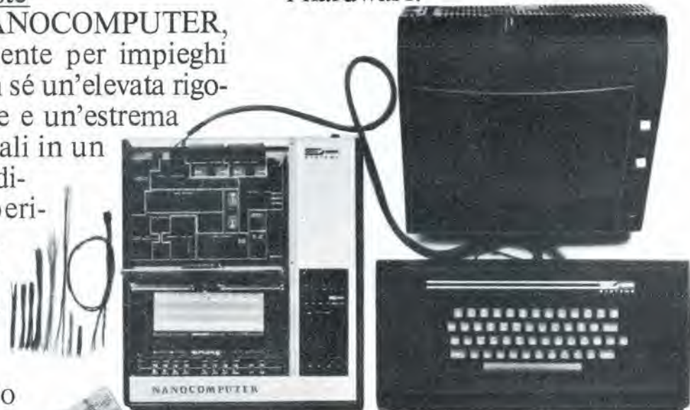
NBZ80-HL. Come NBZ80-S con 16k byte di RAM, tastiera alfanumerica con interfaccia video, 8k ROM di Basic su scheda addizionale, libro Basic Programming Primer, monitor TV (opzionale).
