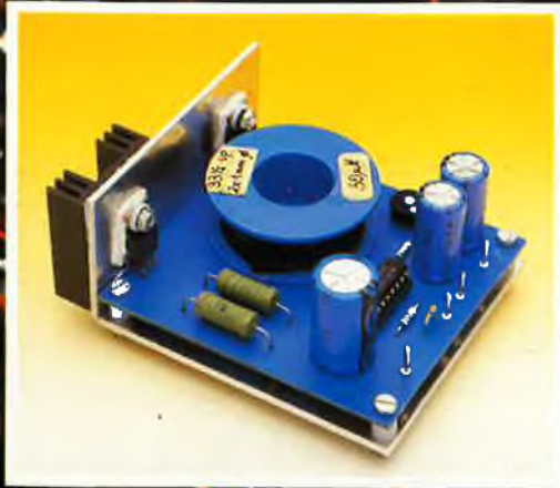
convertisseur de puissance: 12V/28V/4A
