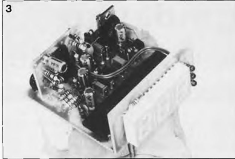
Figure 3. Vue plongeante à l'intérieur du montage terminé. Lors de son implantation dans le boîtier, le montage subit une rotation de 180^\circ , pour permettre aux points décimaux de trouver leur position naturelle.
