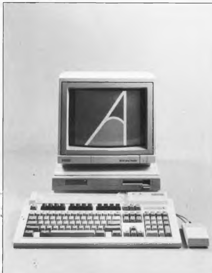
Figure 1. A l'image des ordinateurs les plus récents, Archimedes se compose de deux sous-ensembles: un clavier séparé avec souris et un coffret métallique doté d'un lecteur de disquettes 3 1/2", l'unité centrale.
