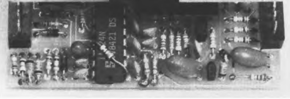
Photo 2. Le module de codage MIC de l'émetteur de Webra. A nouveau un 80C48 effectue la quasi-totalité de la tâche. On n'y trouve pas de convertisseur A/N séparé, le nombre de circuits périphérique est lui aussi très faible.
